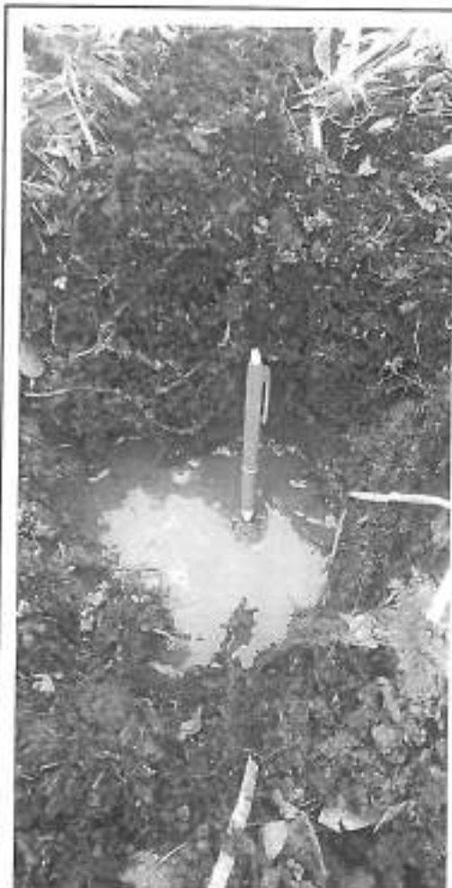
Detaliu sondaj în groapă (se observă infiltrațiile de apă)
